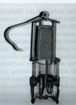
Abb. 33 Schnittmodell einer Sicherheitslampe nach dem Prinzip von Carl Wolf aus den Grubenlampenwerken Zwickau, 1960. Museum Priesterhäuser. Foto: D. Jakob
