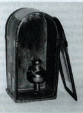
Abb. 31 Freiburger Blende, Holzkasten mit Messingauskleidung zur besseren Lichtreflexion, Mitte 19. Jahrhundert. Museum Priesterhäuser, Foto: D. Jakob
