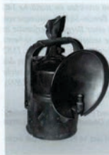
Abb. 32 Karbidlampe mit Spanschraubenbügelverschluss, Handlampe Typ 850 f aus den Grubenlampenwerken Zwickau, 1952. Sammlung Hoy, Foto: D. Jakob
